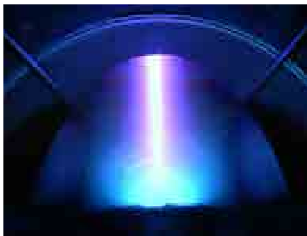
Рис. 2. Світіння над поверхнею підкладки із хромонікелевої неіржавіючої сталі у режимі батутної моди. Геліконне джерело розташоване зверху. Відстань від антени до поверхні зразка складає 450 мм
