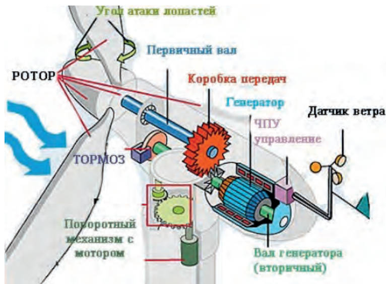
Рис. 1. Схема работы существующей ВЭУ
