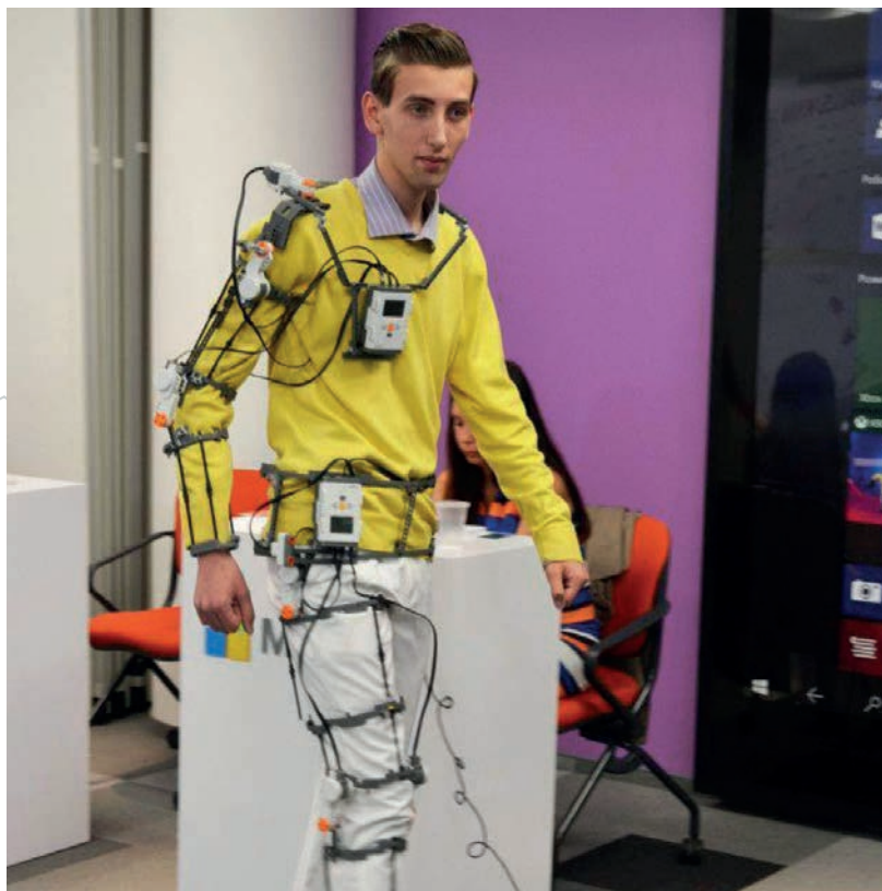
Рис. 2. Демонстрація роботи екзоскелету
