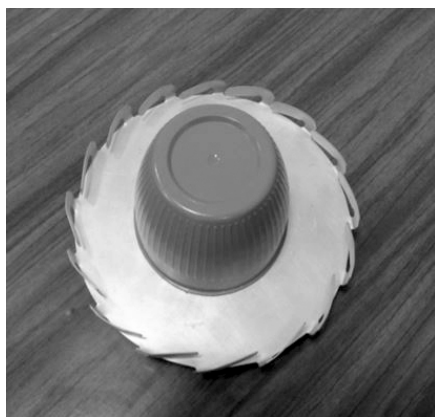
Рис. 1. Зовнішній вигляд широко-смугової антени для засобів мобільного зв'язку
