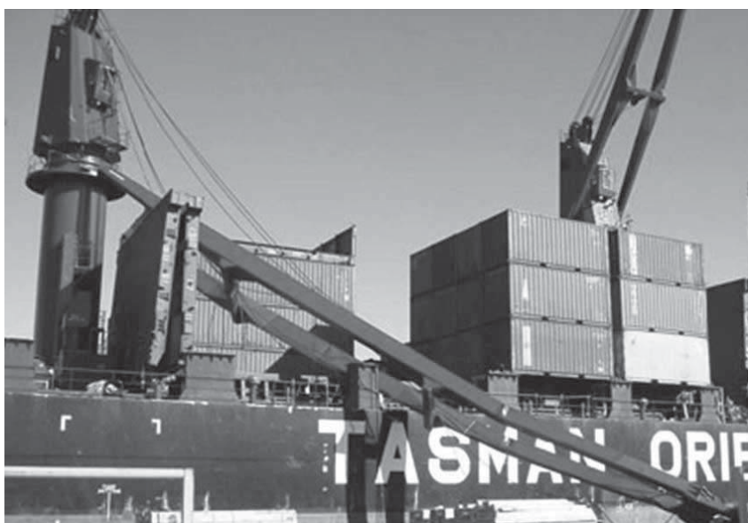
Рис. 1. Кран Mitsubishi (SWL 35 tonnes) в якому причиною падіння стріли став обрив топенанта
