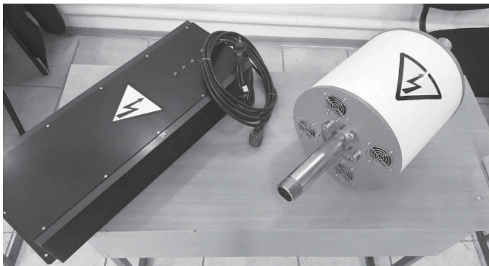
Фото 2. Діючий реально впроваджений зразок ультразвукового кавітатора для знезараження рідин
