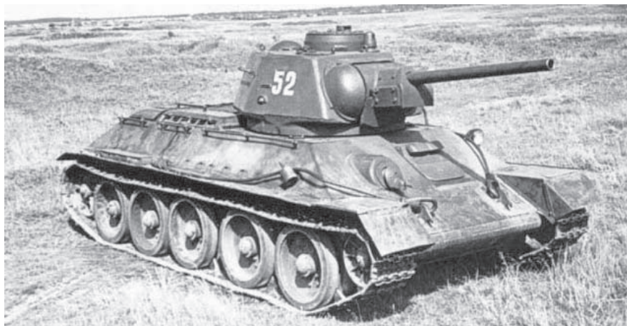
Рис. 1. Танк Т-34 з 76,2 мм гарматою Ф-34
