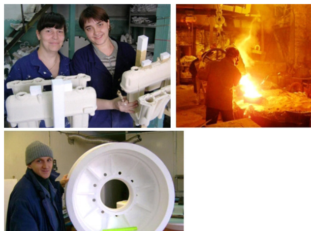
Рис. 6. Модели коллектора ДВС, заливка металлом литейных форм, модель диска катка
