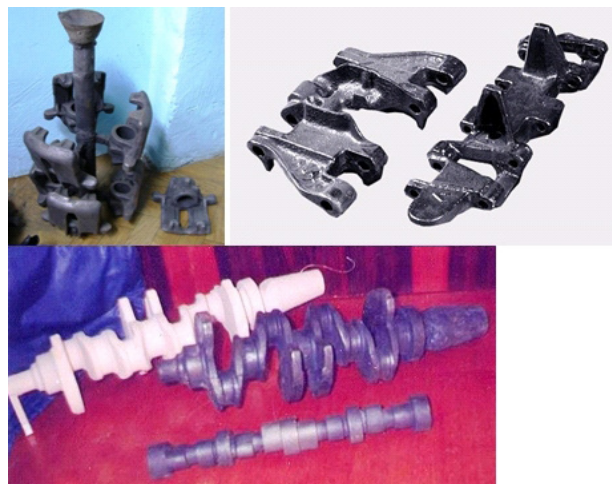
Рис. 5. Отливки суппорта дискового тормоза, траков, коленвала и распредвала.
