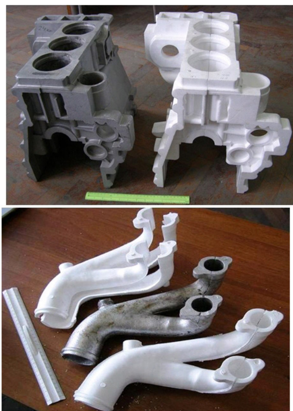
Рис. 1. Модели и детали двигателя внутреннего сгорания.
