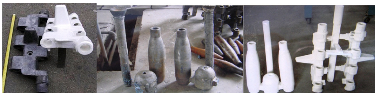
Рис. 3. Отливка и модель трака гусеницы, а также отливки и модели корпусов импульсного разрушения.
