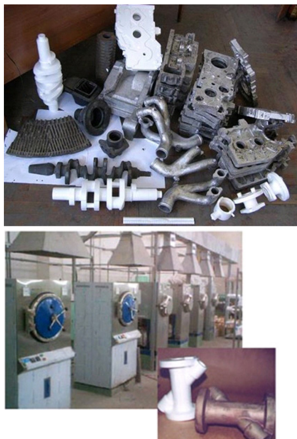
Рис. 2. Различные отливки из области двигателестроения и общий вид модельного цеха.
