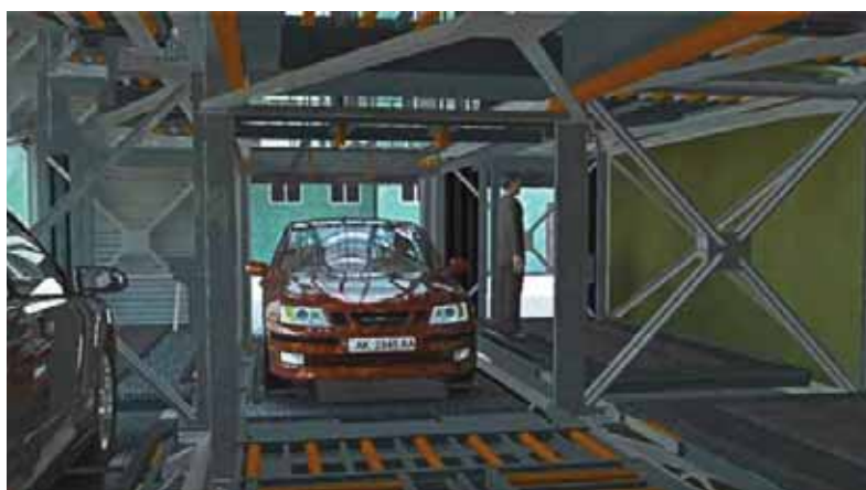
Рис. 9. Фрагмент многоэтажного автоматического паркинга
