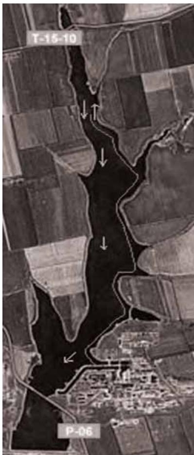
Рис. 1. Схема возможного расположения в Ташлыкском водохранилище гидроизолированного водовода (красной линией показано положение стенки)
