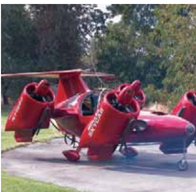
Рис.5а – б. Проект 2 – местного Moller Skycar M400 с вертикальным взлётом/посадкой фирмы Moller International, США.
