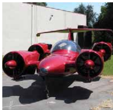
Рис.5а – б. Проект 2 – местного Moller Skycar M400 с вертикальным взлётом/посадкой фирмы Moller International, США.
