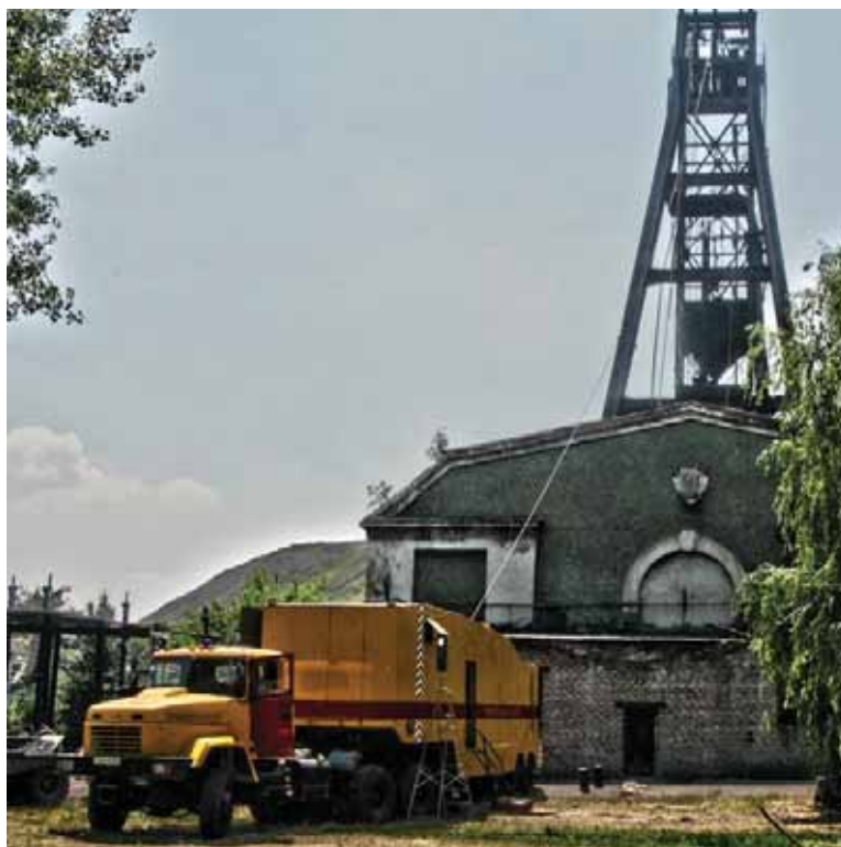
Рис. 7. Використання мобільної підйомної установки при ліквідації наслідків аварії на шахті ім. К.Маркса ДП “Орджонікідзевугілля”
