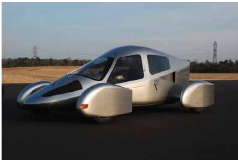
Рис.5. Самый экономичный в мире композитный 4-местный VLC фирмы "Edison2", США
