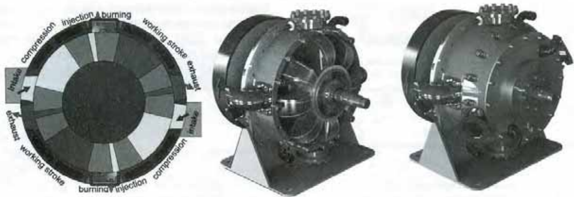
Рис.3. Структурная схема рабочей полости и её конструктивное оформление, а также внешний вид прототипа роторно-лопастного ДВС «ТурбоМотор»
