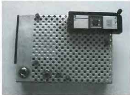
Рис.3. Газовий датчик сірководню в повітрі в діапазоні концентрацій 1,1000 ppm
