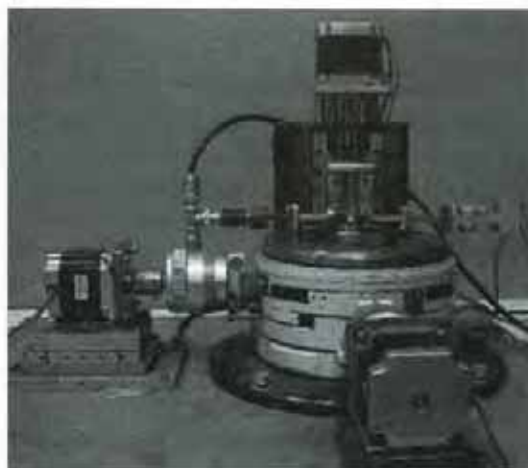
Рис.5. Скануючий мікрохвильовий мікроскоп з мікрохвильовим датчиком резонаторного типу
