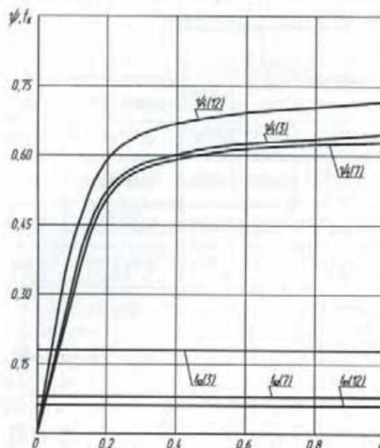
Рис. 4. Безрозмірні теоретичні залежності  $k_x - k_y(t)$  і  $\psi - \psi(t)$  рушія з  $\sigma = 0.35$  МПа при взаємодії з різними ґрунтами: зв'язним щільним (свіжозрізаним) з  $\kappa_r = 12$  МПа; незв'язним щільним (свіжозрізаним) з  $\kappa_r = 7$  МПа; зв'язним рихлим (насипним) з  $\kappa_r = 3$  МПа (значення  $\kappa_r$  позначені на кривих)
