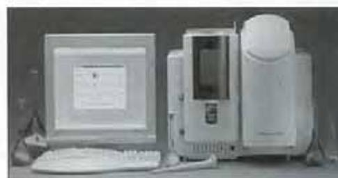
Автоматичний двошпроменеви атомно-адсорбційний спектрометр ThermoElectron
