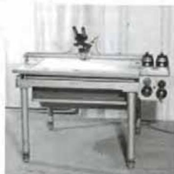
Випробувальна установка для визначення напрямку осей пружної симетрії орієнтованих полімерних плівок та текстильних матеріалів в інтервалі температур (20...200) °C
