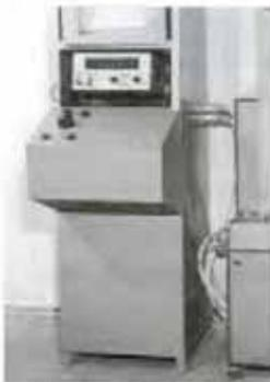
**Випробувальна установка на розтягування текстильних та плівкових матеріалів в інтервалі температур 20–200° С**
