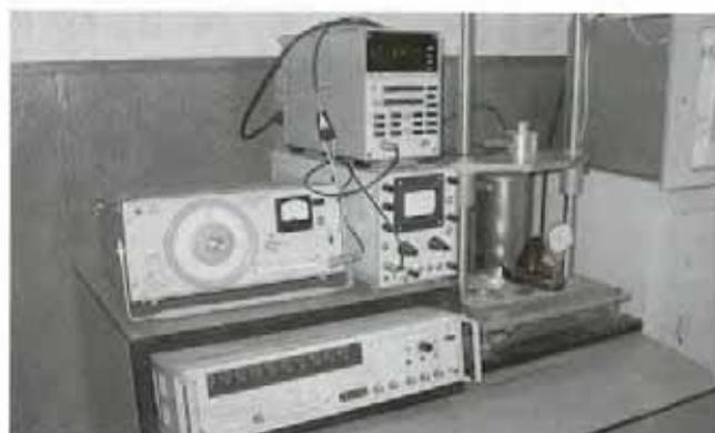
Рис. 1. Низькочастотний спектрометр для резонансних досліджень полімерних плівок та волокон
