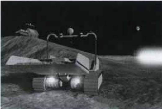
По предварительным расчетам, два 150-килограммовых робота, работая вместе, смогут построить 2,5-метровую в высоту, 48-метровую в длину насыпь вокруг посадочной площадки (для защиты будущего поселения) всего за 6 месяцев, а строительством самой площадки займутся другие роботы, меньше по размеру.
