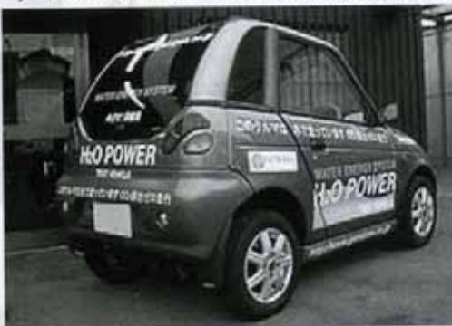
ла название Water Energy System (WES). Она устроена по тому же принципу, что и другие силовые установки на топливных элементах, использующие водород в качестве топлива.
