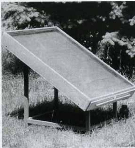
Фото 1. Адсорбционный солнечный генератор пресной воды пл. 1 м<sup>2</sup>
