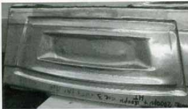
а) Задняя панель кузова автомобиля "Ford", угловые элементы которой отштампованы магнитно-импульсным воздействием;
