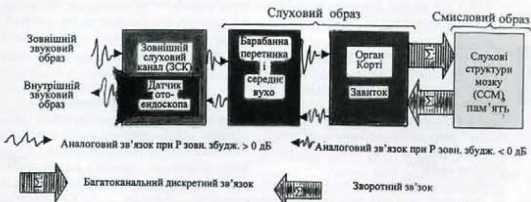
Рис. 3. Структурно-функціональна схема виявлення звукових сигналів, що емітуються органом Корті.
