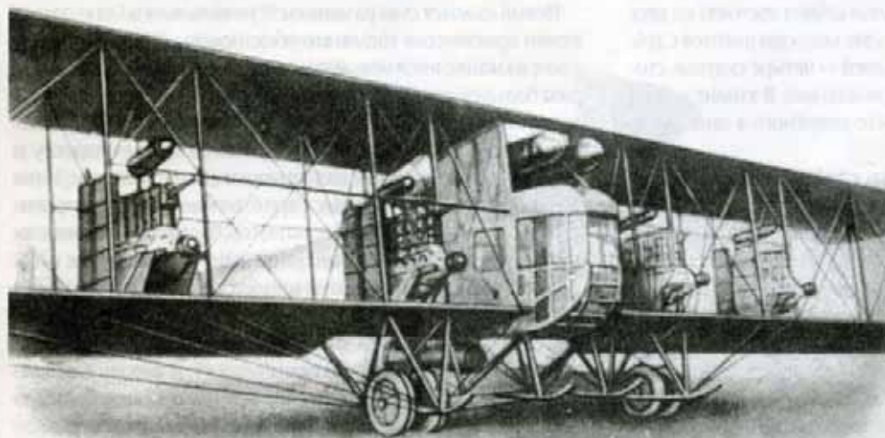
Самолет "Илья Муромец" серии Б с двигателем РБВЗ-6 с подвешенной 25-пудовой бомбой
