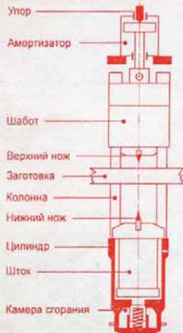
Рис. 9. Схема МИР и торцы заготовок после импульсной резки: а – квадрат 205x205 мм, конструкционная сталь, б – круг Ж 160 мм, углеродистая сталь для труб, в – прямоугольник 60x270 мм, сплав Х20Н80
