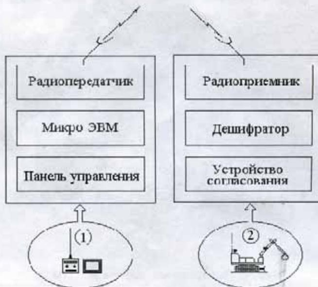
Рис. 5. Структурная схема системы дистанционного управления
