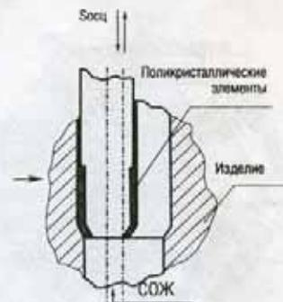
Рис. 6. Принципиальная схема доводки редуцирующей зоны канала твердосплавных холодновысадочных матриц
