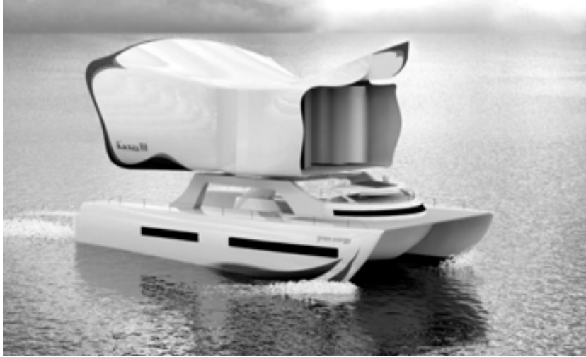
Рис. 1. Загальний вигляд яхти-катамарана, що має електродвигуни як у звичайного судна, але основним рушієм якої є активна енергетична вітрильна установка нового типу. Це активне вітрило типу «Каскад», спроектоване, побудоване і випробуване в Україні, у місті Херсон на річці Дніпро підприємством Premizlab UA.
