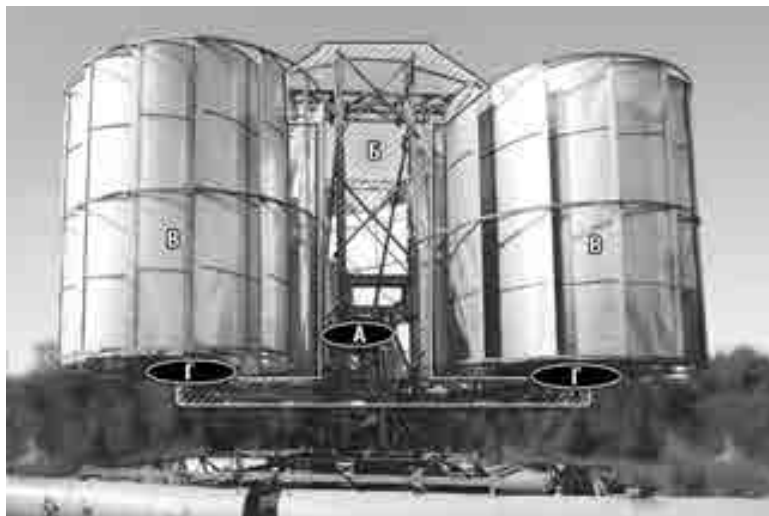
Рис. 2. Пристрій активного вітрила. Воно складається з поворотної опори (поворотний підшипник великого діаметра) (А), на якій встановлено каркас обтічника (Б) і дві вертикальні турбіни (В) карусельного типу. Установка також має під турбінами на несучих фермах електричні генератори з мультиплікаторами (Г).
