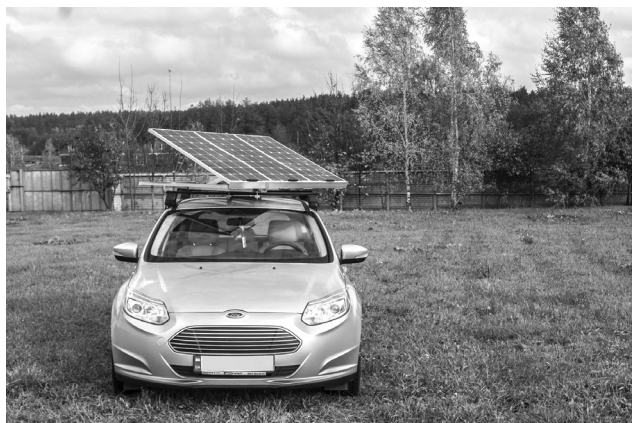
Рис. 1. Сонячна панель на стоянці в орієнтованому положенні (ліворуч) і в положенні для руху транспортного засобу (праворуч)
