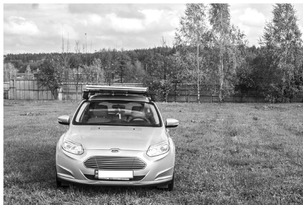
Рис. 1. Сонячна панель на стоянці в орієнтованому положенні (ліворуч) і в положенні для руху транспортного засобу (праворуч)
