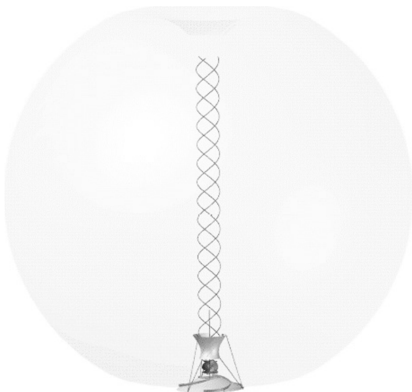
Рис. 6. Штучний торнадо при роботі вітроелектростанції
