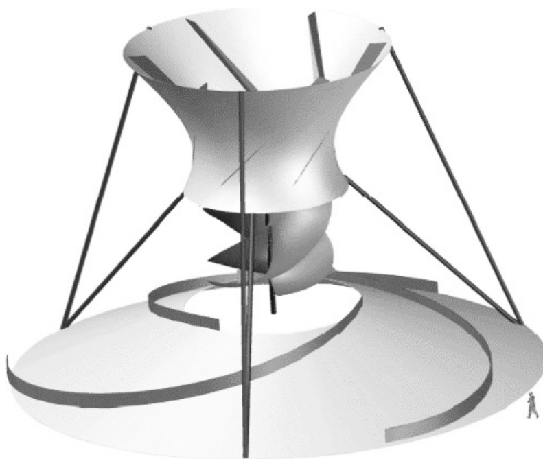
Рис. 5. Приклад тороїдальновихорної вітроелектростанції
