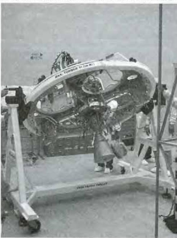
Монтаж рідинного ракетного двигуна в компанії AVIO
