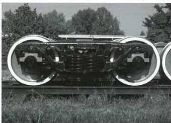
Малюнок 1 – Візок моделі 18-7020 з навантаженням від колісної пари на рейки 23,5 тс
