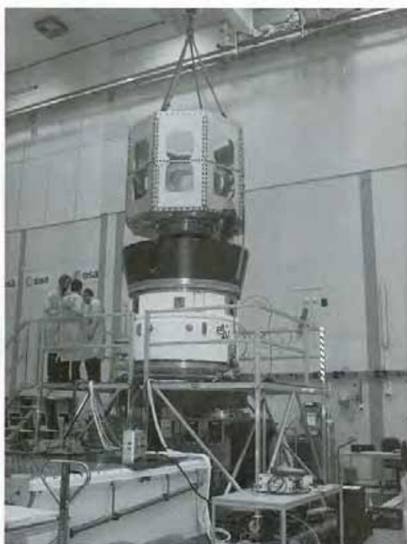
Монтаж ступеня ракети-носія «Вега» на випробувальний стенд
