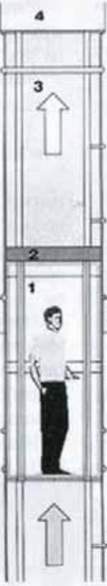
1 – зона атмосферного давления; 2 – поршень на вершине кабины; 3 – зона разрежения; 4 – насос ®
