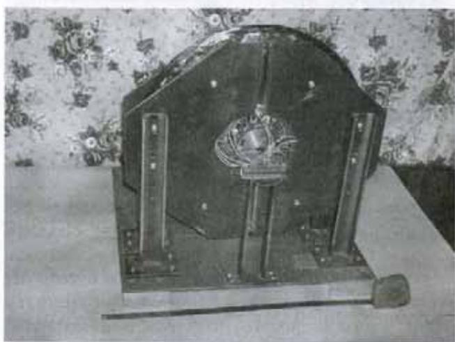
**Рис. 5. Модель дискового двигателя с четырехконтурным полем (патент 61727 С2)**
