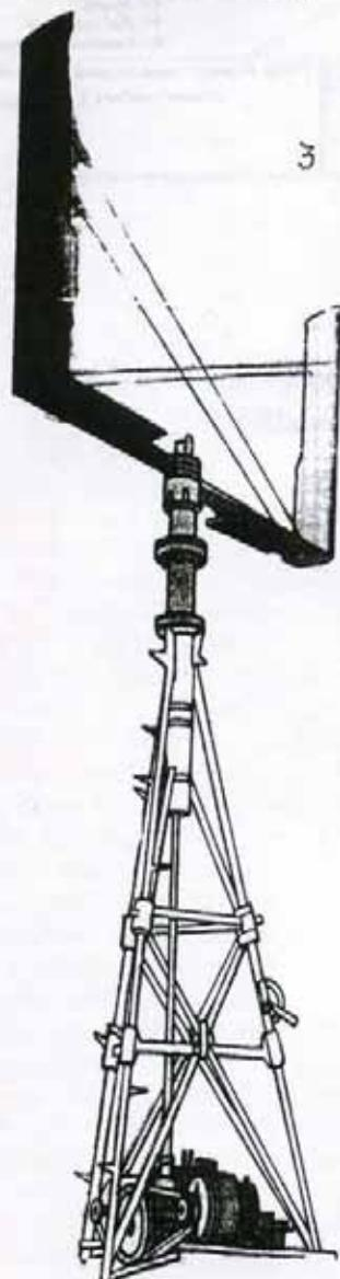
побудована в 1901—1904 роках. Вона являла собою великий рефлектор, що автоматично рухався за Сонцем. На внутрішній стороні рефлектора розміщались 1000 дзеркал, які відбивали і концентрували сонячну енергію на котел (кип'ятильник). Станція використовувалась для накачування води при поливанні рослин.
