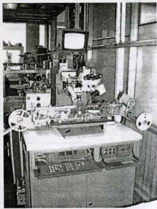
Рис. 5. Установка приварки траверс к нагревателям
